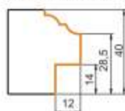
profil wzdłużny świetlika
